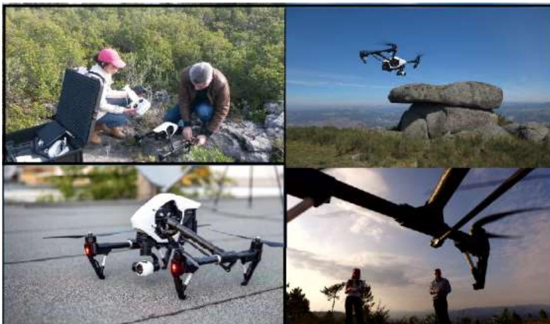
**Figura 2.**Exemplo de utilização de VANTs para obtenção de dados de imagens, vídeos e modelos digitais de superfície. Pode-se observar a boa resolução da Câmera e a funcionalidade de rotação do conjunto Gimbal/Câmara ainda em processo de pouso. Neste caso, o modelo DJI Inspire 1, acoplado de câmara ZenMuse X3. Concelho de Alvaiázere – Pt, 2015.
